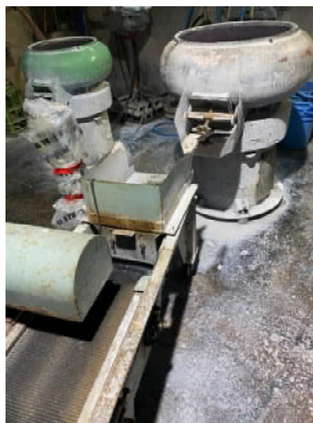
図 11 バレル研磨機（奥）と磁石式選別機（手前）
