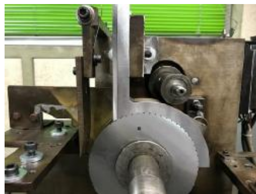
図9 両尖頭したハリを一本バリ用にカットする中切機
