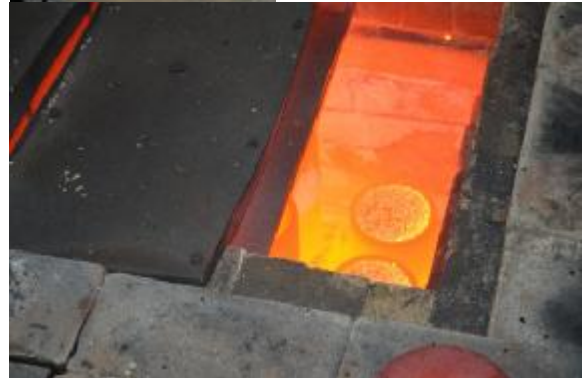
図10 焼き入れ前のルツボ (上) 浸炭中の炉内 (中) オーステナイト状態になったハリを水槽に入れた瞬間 (下)
