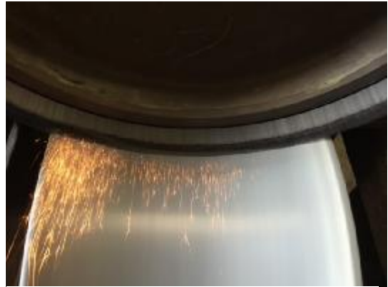
図7 尖頭器によるハリ先の研磨
