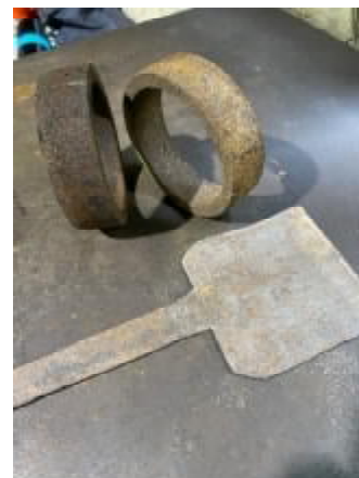
図8 ジアゲ工程に用いている鉄製リングと鉄バラ
